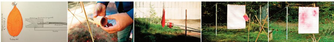
Abb. 7-11: Sprengung mit einer gerichteten Ladung
